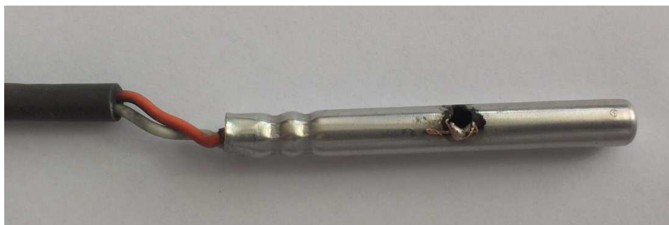
Foto: Kolektorový snímač teploty po zásahu bleskom
